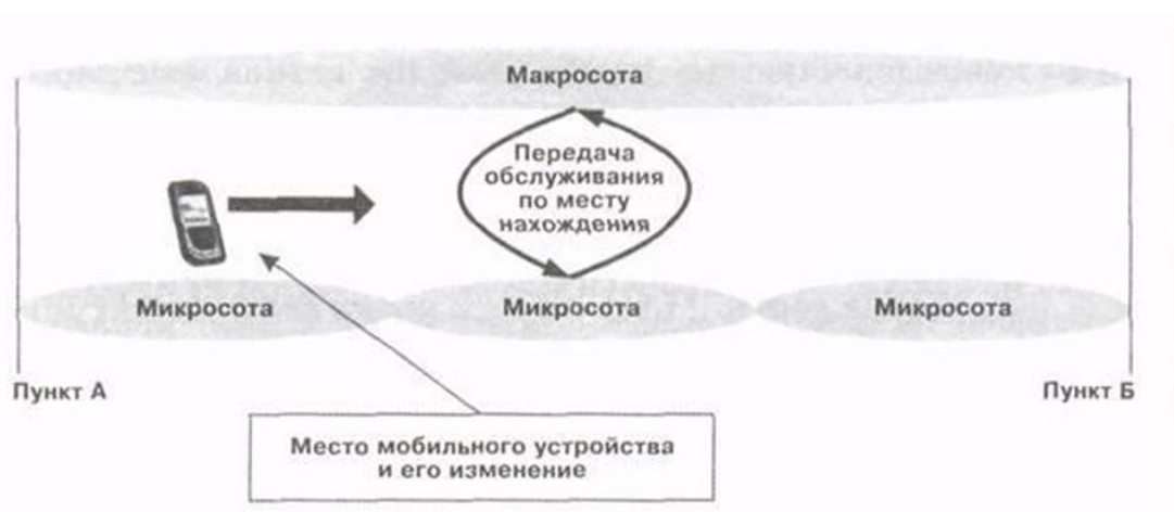
Рисунок 2.4 – Пример передачи обслуживания (хэндовера) с использованием информации о местоположении
