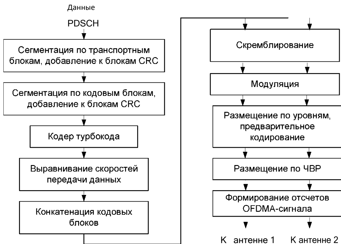
Рисунок 2.10 - Структурная схема кодирования данных канала PDSCH
